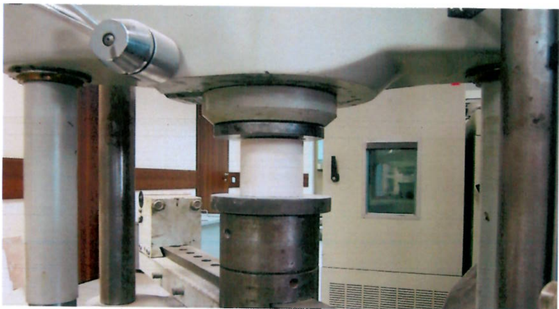
Фото 3. Установка образца-цилиндра, изготовленного из стенового блока YTONG для испытаний на сжатие.
