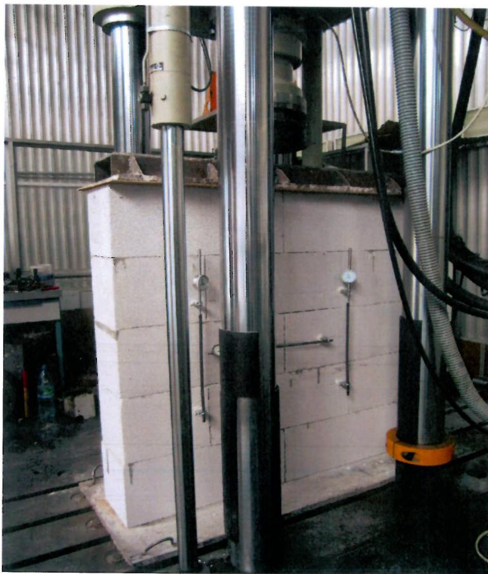
Фото 1. Схема установки образца кладки на стенде и схема размещения измерительных приборов.
