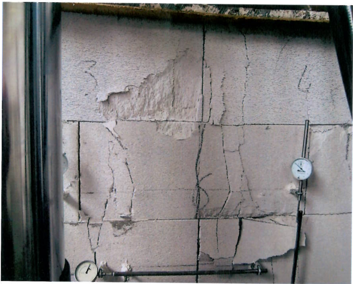
Фото 2. Разрушения образца кладки при максимальной нагрузке.
