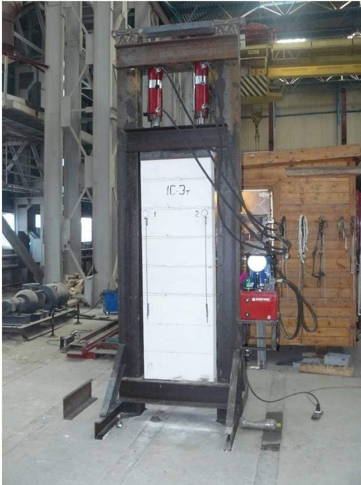
Рис. 4. Общий вид до испытания опытных образцов I-ой серии (а) и II-ой серии (б) на центральное и внецентренное сжатие
