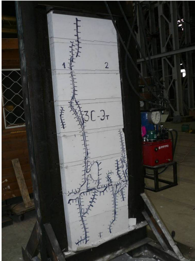
Рис. 5. Характер разрушения образцов I-ой серии (а) и II-ой серии (б) на центральное и внецентренное сжатие после испытаний
