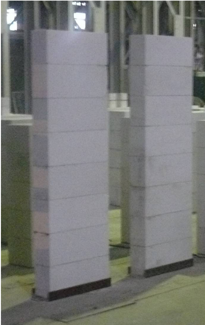
Рис. 1. Общий вид опытных образцов стен I-й серии для испытаний на центральное и внецентренное сжатие
