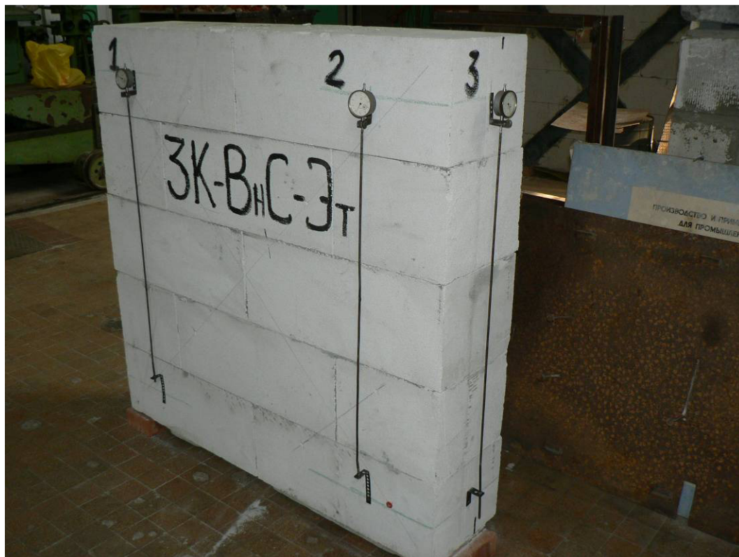
Рис. 2. Общий вид опытного образца II-й серии для испытаний на центральное и внецентренное сжатие
