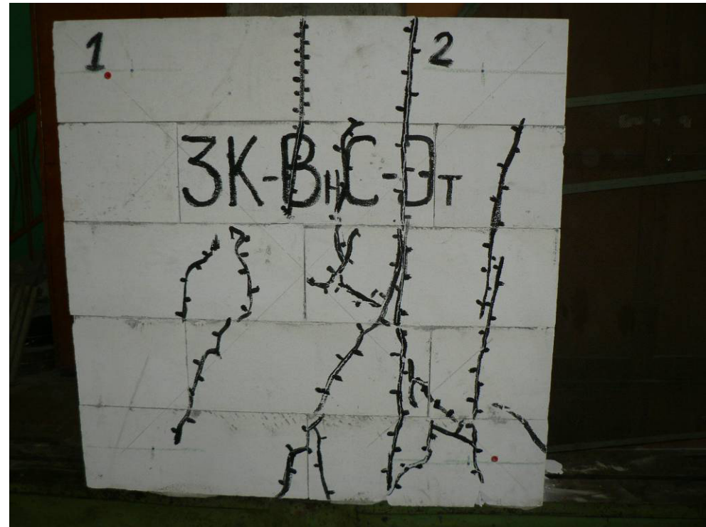
Рис. 5. Характер разрушения образцов I-ой серии (а) и II-ой серии (б) на центральное и внецентренное сжатие после испытаний
