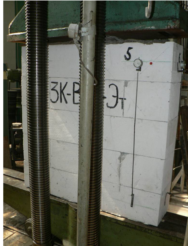
Рис. 4. Общий вид до испытания опытных образцов I-ой серии (а) и II-ой серии (б) на центральное и внецентренное сжатие
